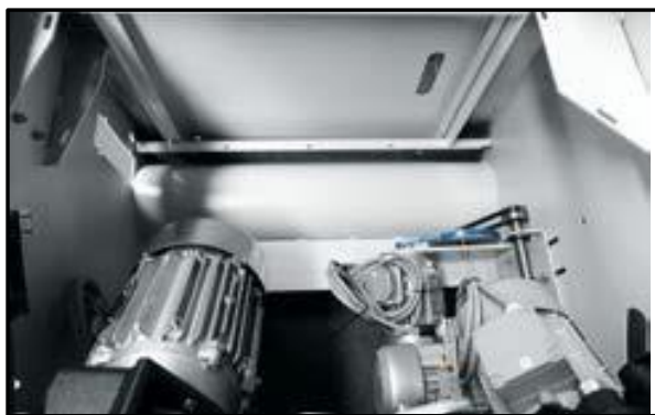
Tubo de Torsión relleno de Concreto para absorber Vibración
