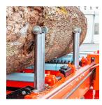
Prensa sujetadora hidráulica y tres soportes verticales
