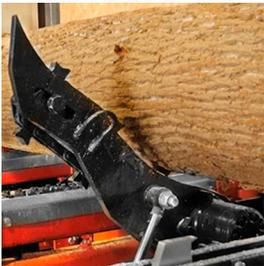
**Dos rotores de troncos hidráulicos con cadena bidireccional**
