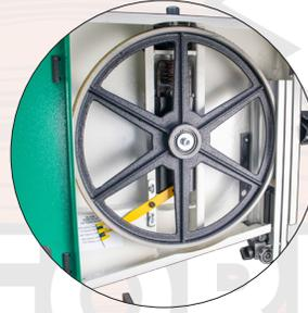
Volantes fabricados en acero de fundición para una durabilidad excepcional.
