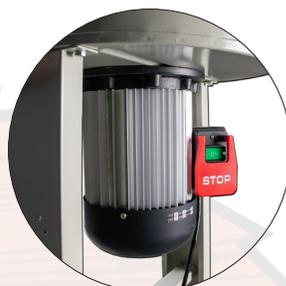
Potente motor de 7.5 HP en fundición de aluminio para una mayor disipación del calor.
