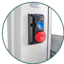
Botonera de arranque y paro para un control conveniente de la sierra.
