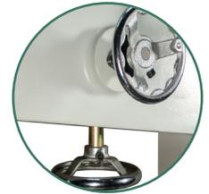
Manivelas que permiten ajustes precisos, mejorando la facilidad de uso y el control sobre los cortes.
