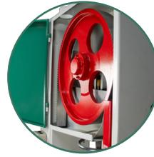
Volantes planos fabricados en acero de fundición para una durabilidad excepcional.
