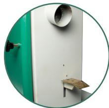
Pedal de freno de emergencia con microswitch que corta inmediatamente la energía del motor para una mayor seguridad operativa.
