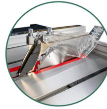
Cubierta de seguridad ajustable con sistema antirretorno, cuchilla separadora y protector de disco.
