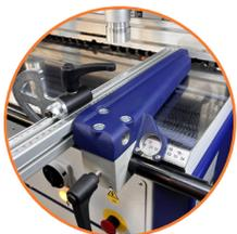
Barras de aluminio con escala en centímetros para una medición precisa. Incluyen topes ajustables que puedes colocar libremente.
