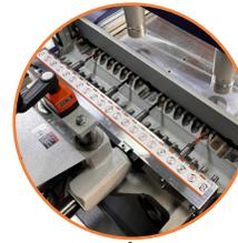
21 husillos con una separación de 32 mm para perforaciones uniformes y eficientes.
