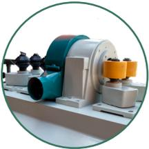
Sistema de recepción con doble rodillo recubierto de goma que protege el producto terminado al evitar marcas o daños.
