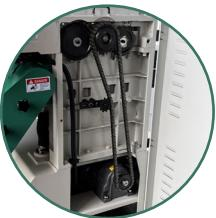
Sistema de elevación mediante cadena para un movimiento seguro y eficiente.
