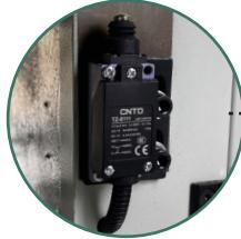
Interruptor de límite momentáneo de tipo émbolo para un ajuste preciso de la altura.
