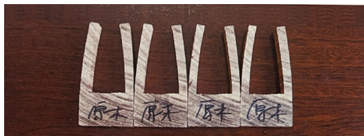
Cambio de estrés de la madera después del secado convencional.
