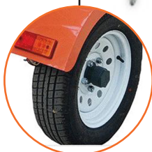
Chasis tipo remolque con llantas 165/70R13.
