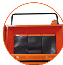
Alimentación hidráulica por rodillos.
