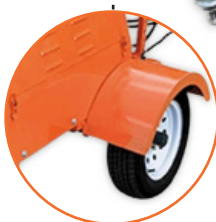
Chasis tipo remolque con llantas 165/70R13.
