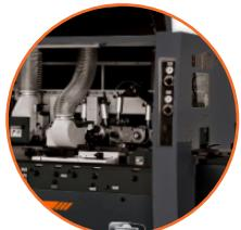
Procesado de cuatro caras en una sola pasada, garantizando precisión y homogeneidad en el acabado
