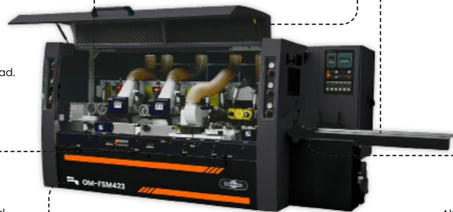
Solución de cuatro ejes para moldurar y cepillar simultáneamente las cuatro caras de la pieza.
