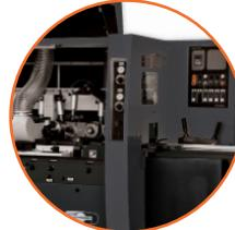
Máquina versátil con 5 ejes para realizar cepillado y moldurado de 4 lados en una sola pasada.
