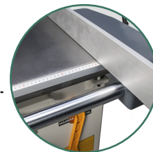
Guía lateral que permite ajustar la distancia entre el disco para facilitar cortes con exactitud.
