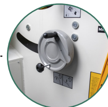
Ajuste de inclinación para realizar cortes en ángulo de hasta 45°.
