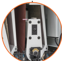
Rodillos con balance dinámico, sin marcas "S".
