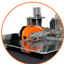
Recibe palos curvos cuadrados y los redondea a diámetro 20 mm a 35 mm.
