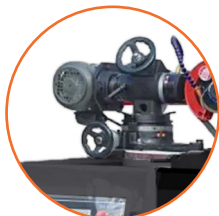
Motor monofásico 220V de 3/4 HP.
