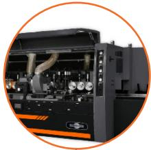
Seis ejes de alta potencia para moldurar y cepillar en una sola pasada.
