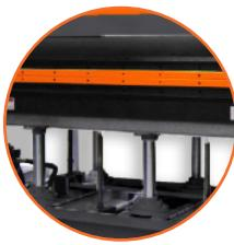
Su presión hidráulica de 100 toneladas permite un prensado uniforme en materiales de mayor espesor.
