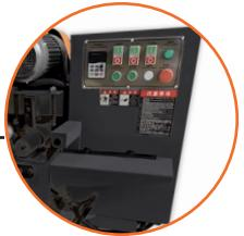
Avance regulable 5 m/min a 20 m/min mediante inverter de frecuencia.
