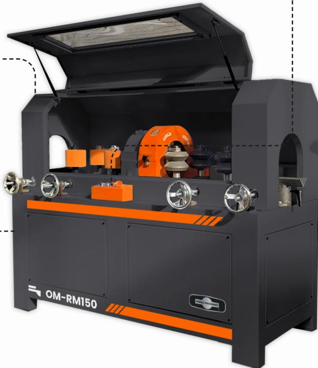
Velocidad de avance ajustable 1.5 m/min a 2.5 m/min mediante inverter de frecuencia.
