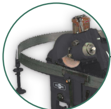
Afilador automático para sierras swage.
