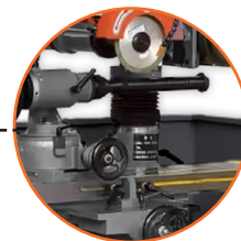
Afilador universal para discos, cuchillas, fresas y brocas.
