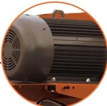
Motor eléctrico 18.6 kW (25 HP) por cabezal.
