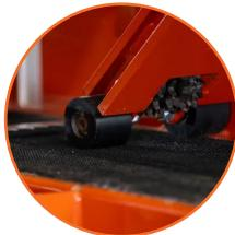
Bancada inclinable 0°–8° para fabricar tablillas de solape.
