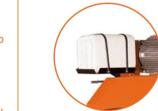
Sistema de lubricación de la sierra con depósito de 18.9 L.
