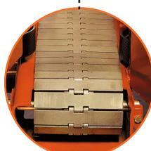
Velocidad de avance (variable) 0–30 m/min con transportador de banda de acero.
