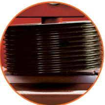
Rodillos guía de la sierra y rodillos prensores laterales angulados.
