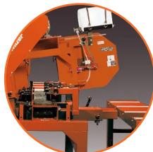
Bancada inclinable 0° – 8° para producir tablillas tipo lap-siding.
