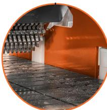
Velocidad de avance (variable) 0–20 m/min con doble Transportador de banda de acero.
