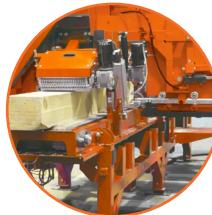
Altura de corte hasta 37 cm y mínima de 6 mm.
