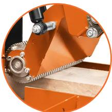
Hold-Down Rollers motorizados con sensor neumático.
