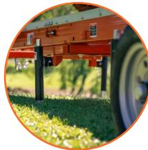
Bancada box-steel reforzada con 6 soportes laterales Quick-Set con rodillos.
