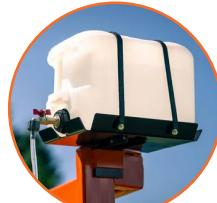
Lubricación automática de la sierra (18 L) y tensión cam-lock.
