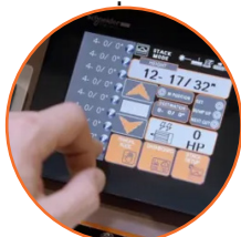
Setworks industrial con servomotores para subida/bajada y avance.
