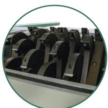
Capacidad de corte con cabezal estándar de 9" expandible a 14". 128 pastillas de carburo de tungsteno instaladas en versión estándar.
