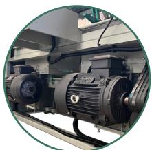
Potencia doble con dos motores eléctricos de 20 HP cada uno.
