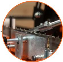
Sensor de apagado automático.
