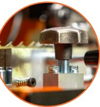
Ajuste mediante una sola perilla para afilar sierras de 1" a 2" de ancho.
