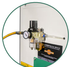
Sistema neumático que optimiza el uso del disco de 18".
