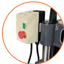
Arrancador magnético con botón de paro de emergencia, utilizado para encender y apagar el cepillo de forma segura.
