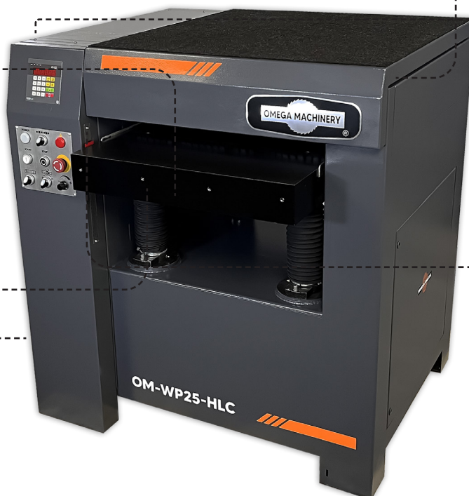
Motores potentes para corte, alimentación y elevación.
