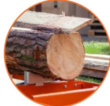
Corta troncos de hasta 56 cm de diámetro y 55 cm de ancho de corte.
