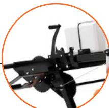
Accionamiento "Rev & Run" mediante embrague centrífugo.
