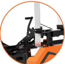
Accionamiento "Rev & Run" mediante embrague centrífugo.
