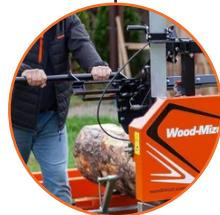
Subida/bajada de cabezal rápida mediante manivela con escala de corte.
