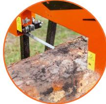
Corta troncos de hasta 56 cm de diámetro y 55 cm de ancho de corte.
