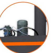
Motor de sistema hidráulico de 4 kW (5.5 HP).
