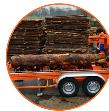
Longitud máxima de corte 6.2 m (extensible)
