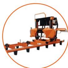
Configuración ampliable con extensión de bancada, accionamientos eléctricos y accesorios para manejo de troncos
