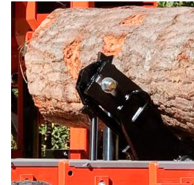
**Rotor de troncos hidráulico de cadena bidireccional**
