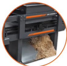
Producción de viruta de hasta 500 kg/h
