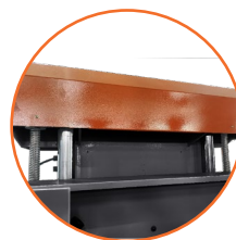
Sistema de elevación y rodamientos lineales cilíndricos de ajuste micrométrico con motorreductor
