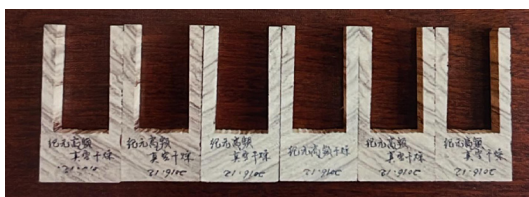
Cambio de estrés de la madera después del secado de alta frecuencia.
