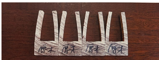
Cambio de estrés de la madera después del secado convencional.
