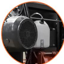
Sistema hidráulico de tensión de la sierra y lubricación automática de la sierra.
