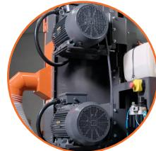
Dos cabezales con motores eléctricos 18.6 kW (25 HP) cada uno.
