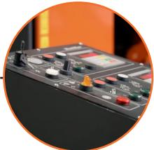
Setworks digital doble con ajuste independiente por cabezal.
